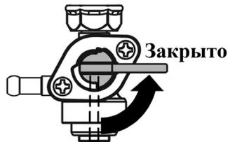
Рис. 12 Топливный кран закрыт
