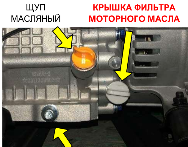
БОЛТ СЛИВА МАСЛА ИЗ ДВИГАТЕЛЯ
