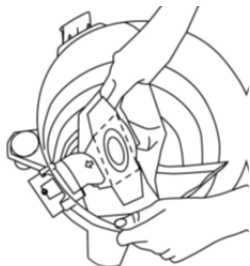
Установка бумажного мешка
