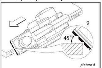
V-образные пазы в передней части базовой пластины позволят быстро и легко скашивать кромки заготовки. В зависимости от требуемой ширины скоса используйте соответствующий V-образный паз. Для этого поместите рубанок с V-образным пазом на край заготовки и направьте его вдоль края.
