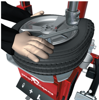
Рисунок 5 – Снятие шины с диска
