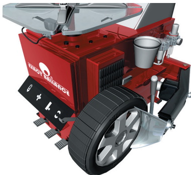
Рисунок 4 – Отжим шины от диска
