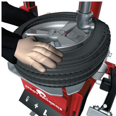
Рисунок 6 – Установка шины на обод
