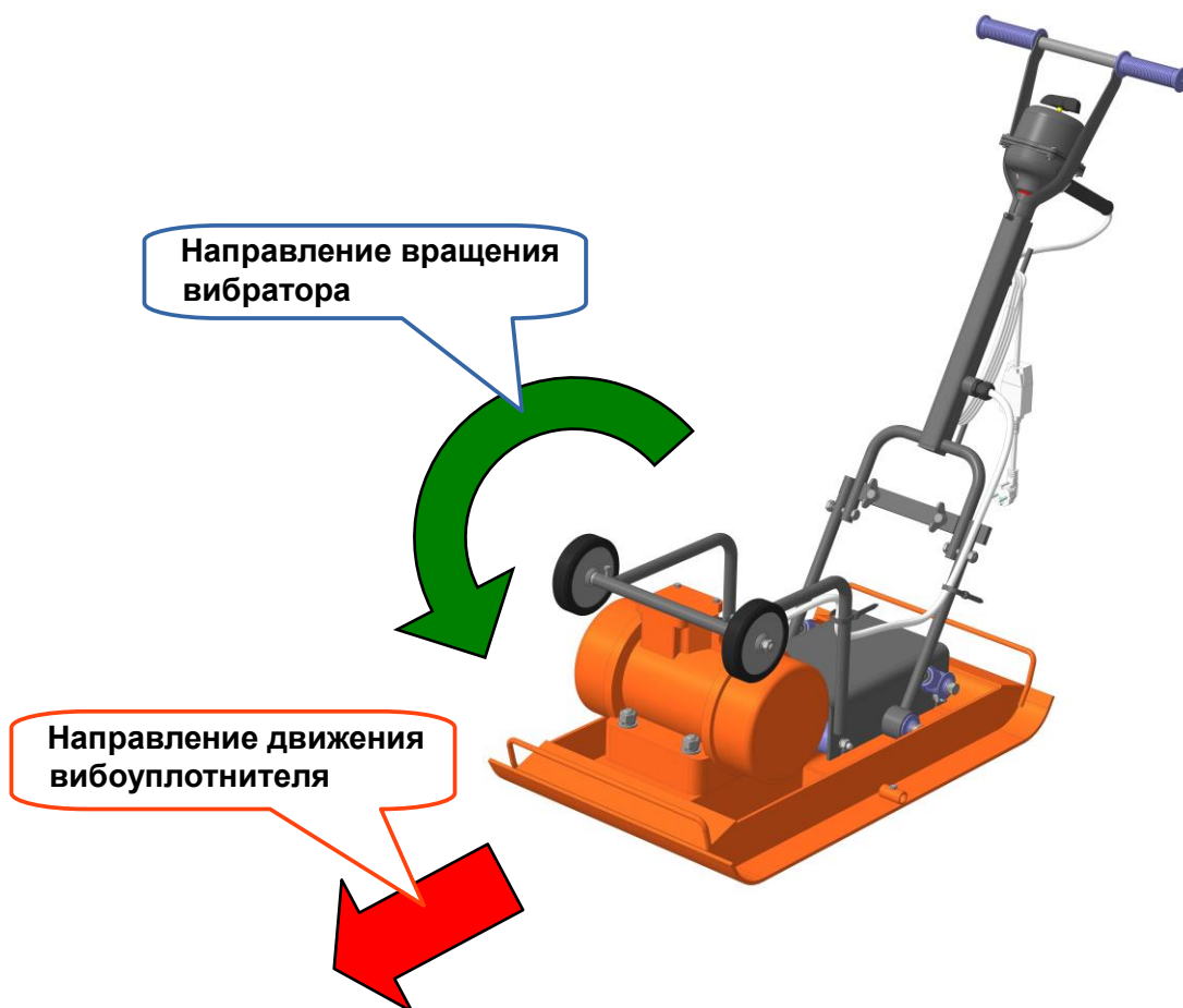
Рисунок 4. Схема направления движения виброуплотнителя.
