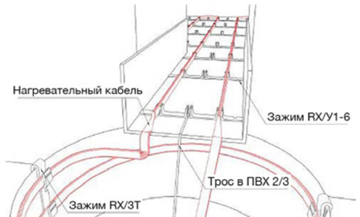
Рис. 4 (Монтаж нагревательного кабеля через парапет)
