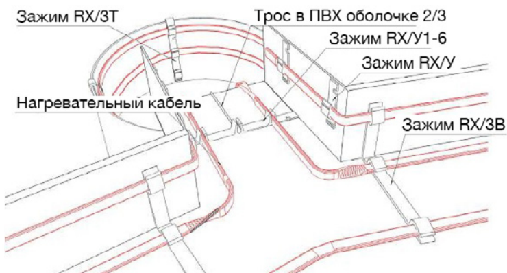
Рис. 4 (Крепление нагревательного кабеля возле водосточной воронки)
