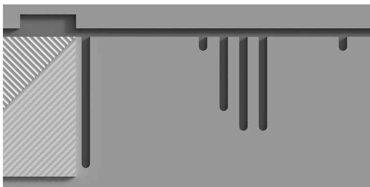
Рис. 4.1 Штробление стены для монтажа электропроводки
