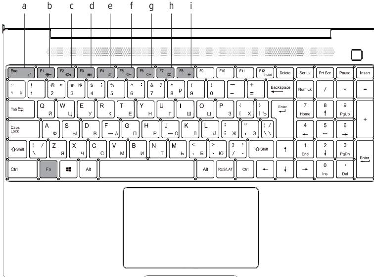
Нажатие и удержание кнопки "Fn" на клавиатуре (18) дает доступ к дополнительным функциям при одновременном коротком нажатии следующих кнопок:
