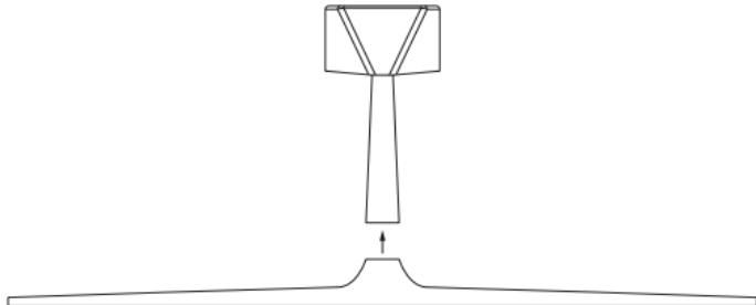
3. Вставьте винт из комплекта поставки в соответствующее отверстие на подставке и закрутите его до упора.
