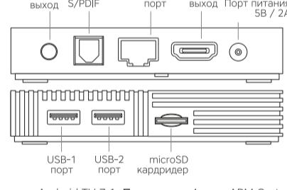
**Спецификация** Операционная система: Android TV 7.1. Процессор: 4 ядра ARM Cortex-A53, 1,2 ГГц. Графический процессор: 5 ядер Mali-450. Аппаратный видеодекодер: Ultra HD 4K (4096x2160). Оперативная память: 2 ГБ DDR3. Флеш-память: 8 ГБ. Wi-Fi: 2,4 ГГц 802.11 b, g, n. Bluetooth: v4.0. Ethernet: 10/100 Мбит/с. Интерфейсы: HDMI 2.0; 2 x USB 2.0 порта, кардридер microSD, Ethernet RJ45, композитный аудио-видеовыход, аудиовыход S/PDIF. Питание: DC 5 В / 2 А.
