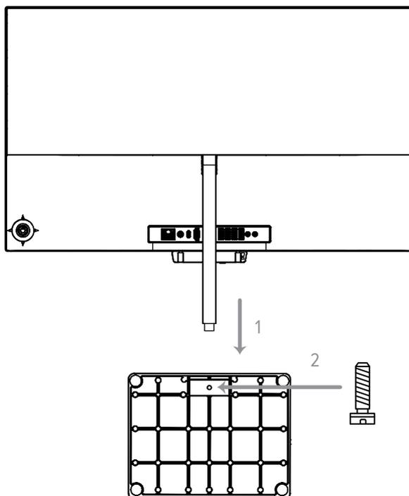
1. Установите монитор в соответствии с положением отверстия.
