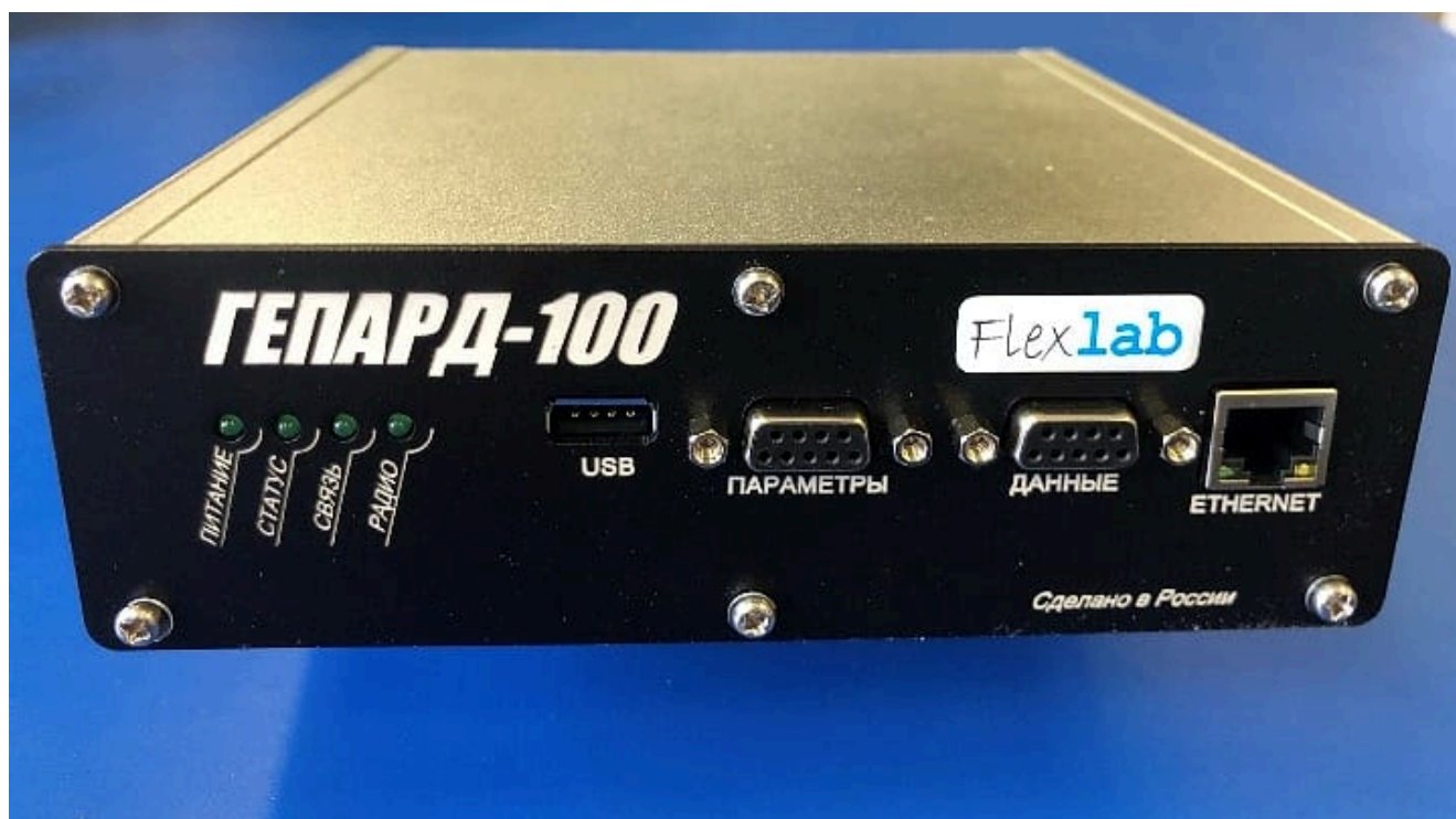
Фото 1. Узкополосный радиомодем «Гепард-100» в типовых корпусах различного цвета.
