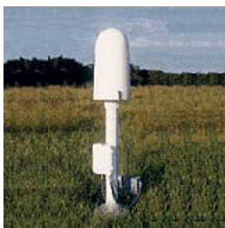
Рис. 1. Общий вид устройства автоматической пеленгации грозовых разрядов ALDF. ( www.ghrc.nsstc.nasa.gov/lightning/lightning-detections.html )
