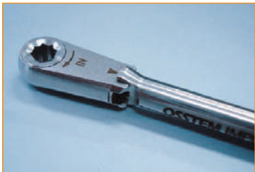
Головка Динамометрического ключа с бесконечным крутящим моментом
