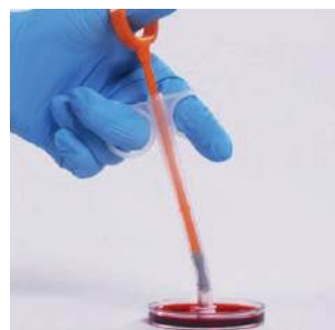
Наличие колец в основании шприца для удобства применения одной рукой.
