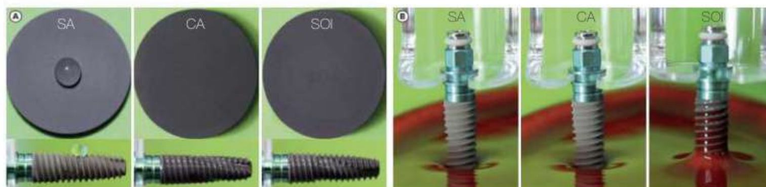
Рис. 1. Оценка смачиваемости поверхности. (А) Угол краевого смачивания – угол между каплей жидкости и твердой поверхностью. (В) Измерение скорости смачивания. Через 40 секунд поверхность SOI характеризовалась наибольшим числом витков резьбы, смоченных кровью. SA: обычная поверхность, прошедшая грубозернистую пескоструйную обработку и травление кислотой; CA: поверхность, прошедшая грубозернистую пескоструйную обработку и травление кислотой, в водном растворе хлорида кальция; SOI: поверхность, прошедшая грубозернистую пескоструйную обработку и травление кислотой и покрытая буферным агентом pH
