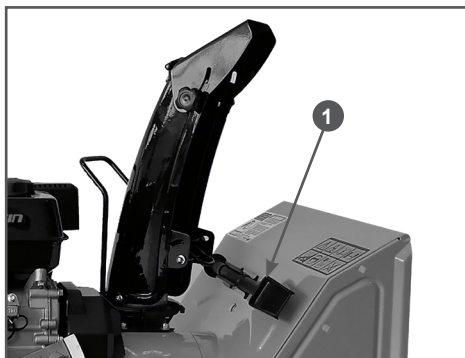
Рис. 26 Расположение лопатки для очистки
