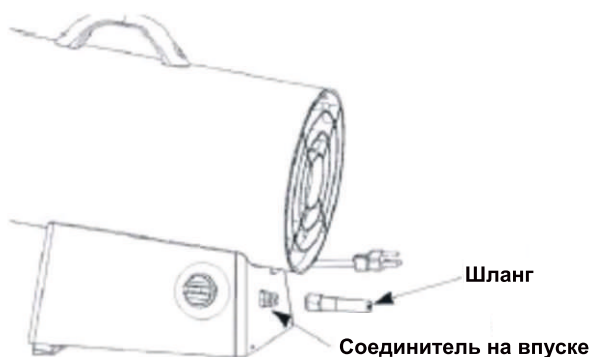
Рис 4. Подключение шланга к выпуску тепловой пушки
