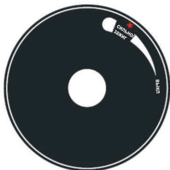
Рис 3. Обозначение положений газового вентиля тепловой пушки
