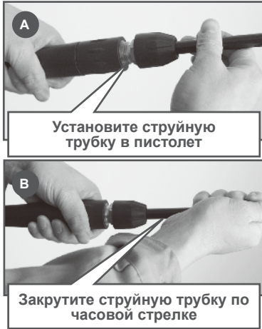
Рис. 5 Установка струйной трубки на пистолет
