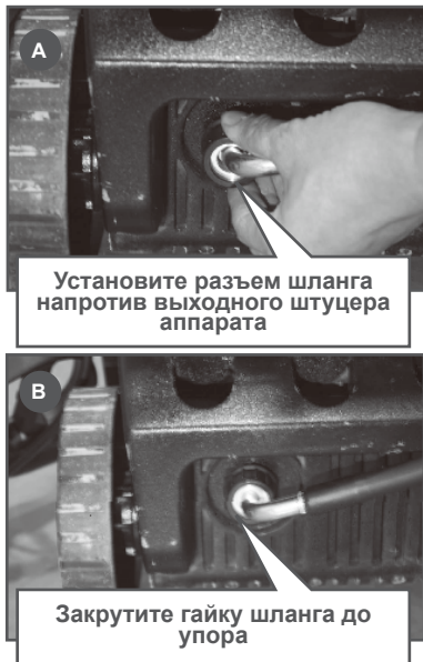
Рис. 4 Подключение шланга высокого давления к аппарату
