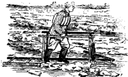
Спасательная лестница с вертикальными стойками и поручнями
