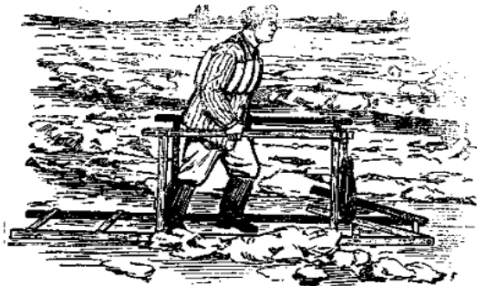
Спасательная лестница с вертикальными стойками и поручнями
